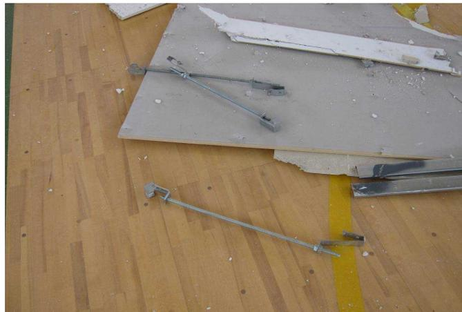
被害により床面に落下した吊り金具、吊りボルト、ハンガー
